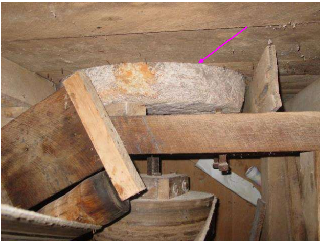
Underneath gristmill; actual working mill stone.
